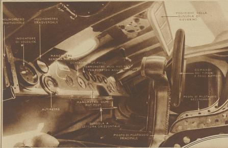
Die Anlage der Instrumente an Bord
