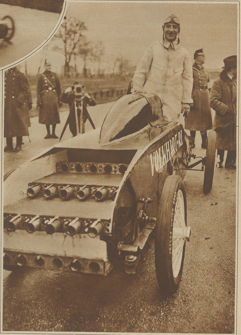
Das Raketenaggregat im Hinterteil des Wagens; im Hintergrund Volkhart
