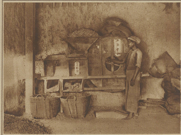
Wie bei uns das Korn, werden die Erdnüsse auf der Windmühle gereinigt, bevor sie geschält und gemahlen werden
