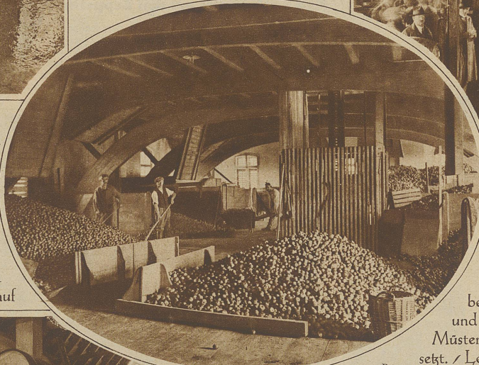
Der Dachboden der Mosterei Egnach dient als Lagerraum. Schüttelroste transportieren das Obst in die Mühlen
