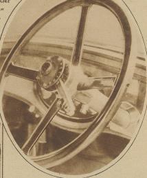
Eine epochemachende Erfindung ist von einer englischen Automobilfabrik gemacht worden. Sie rüstet ihre Wagen mit einem am Steuer angebrachten Hebel aus, der durch einfaches Verschieben auskuppelt und im Getriebe den gewünschten Gang einstellt. Im Bilde steht der Hebel auf Leerlauf. R bezeichnet den Rückwärtsgang und die Zahlen 1-4 die bezüglichen Uebersetzungen
