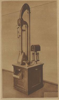
Fernrohrpost - Einzelstation mit Hochdruck - Empfangs - und Sendeapparat und optischem Büchsenzähler, wie er für die Bank-linien verwendet wird
