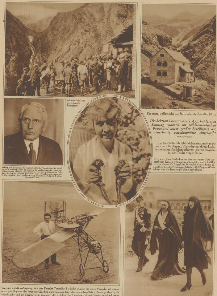
neuartigen Flugzeug des Ingenieurs Zaschka unternommen. Die rotierenden Traglfächen dienen gleichzeitig als Hubschraube und ein Kreiselsystem garantiert die Stabilität des Flugzeuges, dessen Antrieb nur durch einen winzigen Motorrad-Motor erfolgt. Der Apparat kann senkrecht aufsteigen und landen
