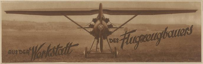
Jagdflugzeug A. C. 1. Leichtmetallkonstruktion, Schalenrumpf, Flügel und Steuerflächen stoffbespannt. Motor: 420 P. S. Jupiter (luftgekühlt)
