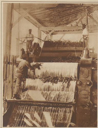
Inneres einer Zuckermühle. Das Mahlen des Zuckerrohrs durch verschiedene, immer enger gestellte Walzensysteme. Der weisse schaumige Zuckersaft fließt in seine Behälter, das Zuckerrohr kommt aus der Mühle so trocken wie Zunder
