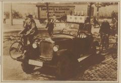
In den Straßen Kölns erregte dieser Tage ein führerloses Auto großes Aufsehen. Durch elektrische Fernsteuerung gelang es, den Wagen in verschiedenen Fahrgeschwindig-keiten gefahrlos durch den Straßenverkehr zu steuern
