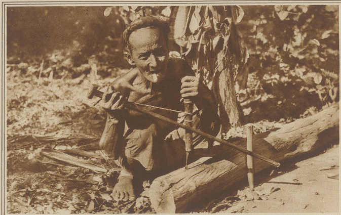
Cochinchina. Anamitischer Zimmermann mit seiner primitiven Bohrmaschine. Durch das Hin- und Herziehen des Stocks wird der mit der Sehne unwickelte Bohrer erstaunlich rasch in das Holz getrieben
