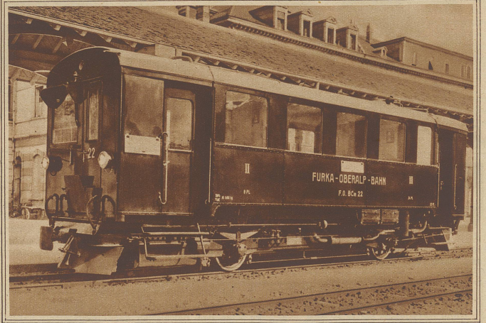
Die Furka-Oberalp-Bahn hat zwei neue von Winterthur gelieferte Benzin-Motorwagen in Dienst genommen, die hauptsächlich während der Zeit verminderter Verkehrsfrequenz vorzügliche Dienste leisten. Der Benzinverbrauch beträgt nur etwa 1/2 Liter pro km Phot. Kettel
