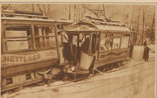
Schweres Straßenbahnunglück in Kassel. Durch Versagen der Bremse raste ein Wagen der Kasseler Straßenbahn bergab, sprang aus den Schienen und rannte in einen ihm entgegenkommenden Tram-wagen hinein. Aus den Trümmern wurden 20 Verletzte hervorgezogen
