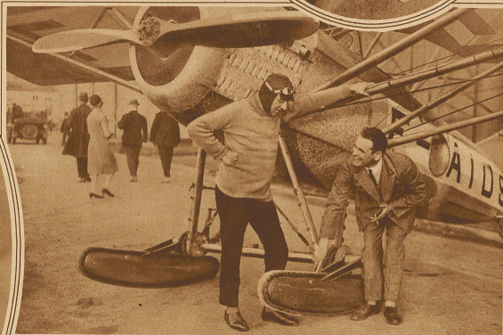
Chevreau, ein französischer Ingenieur, hat auf dem Gebiete des Flugzeugbaues eine bemerkenswerte neue Erfindung gemacht. Er ersetzt die Räder durch Ketten in ähnlicher Form, wie sie die Raupenautomobile tragen. Auf diese Weise soll es möglich sein, die Anlaufstrecke beim Start und vor allem die Landungsfläche auf ein Minimum zu reduzieren
