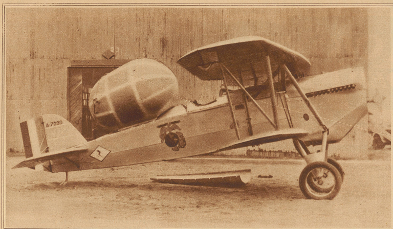
Ein Rettungsballon für Flugzeuge. Für Flugzeuge ist eine neue Sicherung getroffen worden, die vor allem auch für Ozeanflüge zur Anwendung kommen soll. Auf dem Apparat wird ein Ballon montiert, der im Augenblick der Gefahr mit Gas gefüllt werden kann und der für den Fall, daß das Flugzeug auf offene Wasser niedergehen muß, instande ist, die Maschine mit den Passagieren über Wasser zu halten, bis die Rettung erfolgen kann
