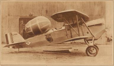
Ein Rettungsballon für Flugzeuge. Für Flugzeuge ist eine neue Sicherung setroffen worden, die vor allem auch für Ozeanflüge zur Anwendung kommen soll. Auf dem Apparat wird ein Ballon montiert, die in Augenblück der Ozelahr mit Ozea spellt werden kann und der für den Fall, daß das Flugzeug aufsoffene Wasser niedersehen muß, instande ist, die Maschine mit den Passigeieren über Wasser zu halten, bie die Rettung erfolgen kann
