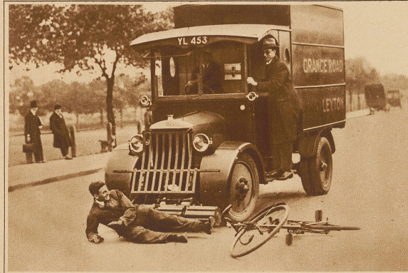
Eine neue Erfindung zur Verhütung von Autounfällen wurde auf einer Londoner Auto-Ausstellung gezeigt. Die am Vorderteil des Wagens angebrachte Rolle bringt bei der leisesten Berührung das Auto sofort zum Stehen
