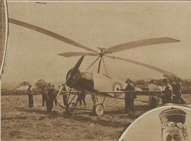
Das neue in England erbaute «Windmühlentypus», dessen Konstruktion ein sehr leichtes Ausfliegen und Landen erlaubt. Die ganze Handhabung des Apparates soll durch einen einzigen Knopfdruck zu fliegen veranlassen, der ein Akkordknopf zu bedienen vermag.
