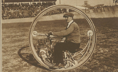
Nach längeren Versuchen ist es dem italienischen Ingenieur Dassi endlich gelungen, diese sonderbare Fahrzeug derart zu verfeinern, daß es praktische Verwendung finden kann. Das Einmal hat einen Durchmesser von 175 cm und wird durch einen Viertaktmotor vorwärts bewegt.
