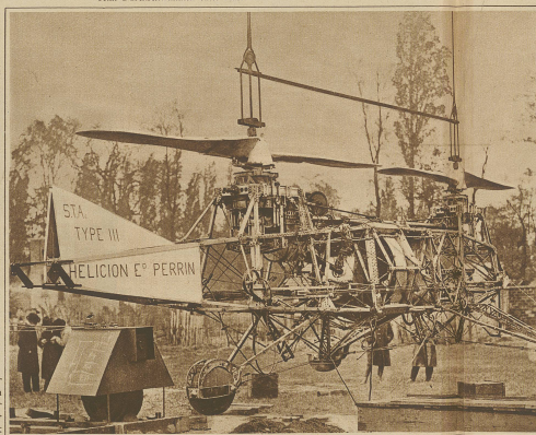
Ein neuer Flugzeugtypus, von Ingenieur E. Perrin erfunden, wird gegenwärtig auf dem Flugfeld von Aspern ausprobiert. Der Apparat besitzt keine Tragflächen, sondern ein horizontal einstellbares Propeller, die von einem einzigen Motor getrieben werden
