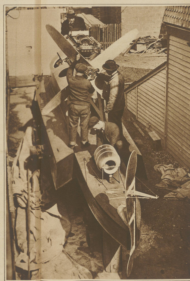
In Amerika werden jetzt verschiedene Typen von Schnellbooten gebaut, die statt Schwanz Propeller zum Antrieb verwenden. Das in diesem Bild ersichtliche Boot verfügt über einen Hauptpropeller, der eine Bandenmotorboote mit 100 Seemeilen entwickelt soll.
