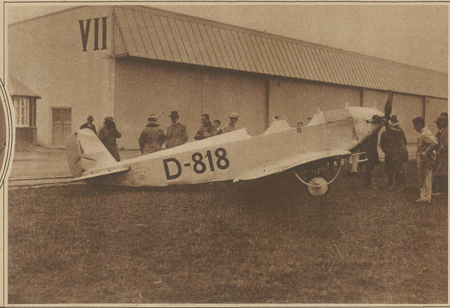
Das neue Mercedes-Leichtflugzeug, das mit nur 20 PS Motorkraft eine Geschwindigkeit von 100 km in der Stunde zu entwickeln vermag und zweisitzig erliegen eine Steishöhe von 3500 Metern erreicht, nach seinem Rundflug über Basel-Göni-Bern auf dem Flussplatz Dübendorf. Die leichte Zerlegbarkeit im Hinblick auf bequeme Unterbringung, der kurze An- und Auslauf und der relativ billige Preis (13 500 Franken) scheinen geeignet, den Apparat zum modernen Verkehrsmittel des Geschäftsmannes
