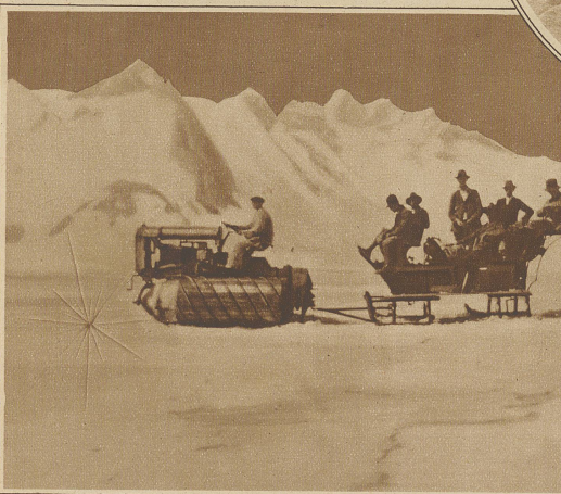
Vorderansicht des Schneemotors. Wie im Bilde ersichtlich ist, werden die Auspuffgase vorn durch die Schlittkufen abgeleitet. Auf diese Weise kann verhindert werden, daß bei kalter Witterung der Schnee an den Kufen hängen bleibt
