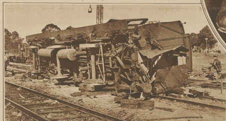
Der aus dem entgleisten Zuge herausgeschleuderte Personenwagen, in welchem die meisten Toten gebunden wurden. Ein neues Eisenbahnunglück in der Nähe Münchens. Letzte Woche entgleiste, wahrscheinlich infolge einer schadhaften Weiche, auf der Station Langenbach der beschleunigte Personenzug Regensburg-München. Dem Unglück fielen 12 Personen zum Opfer
