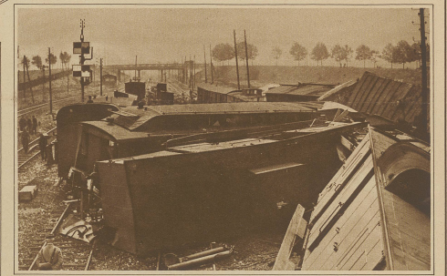
Blick auf das Trümmerfeld des bei Noisy le Sec wegen zu hoher Fahrgeschwindigkeit entgleisten Postzuges
