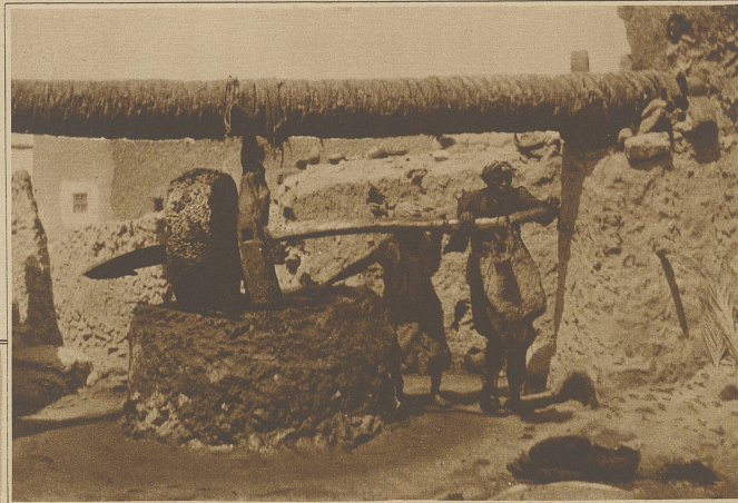
Die primitive Oelmühle, wo die Siwaner die Oliven erstmals quetschen, um ihnen hernach unter einer einfachen Presse das Oel zu entziehen
