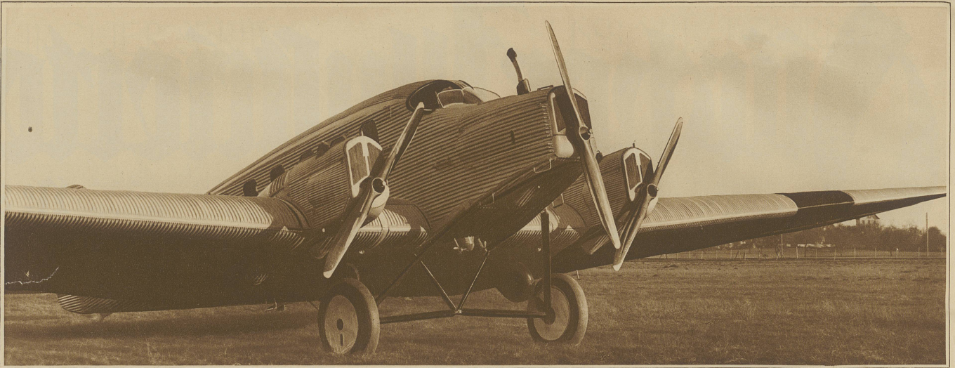
Das neue mit drei Motoren von je 250 P. S. ausgerüstete Junker-Ganzmetallgroßflugzeug vor dem Start zum Alpenflug
