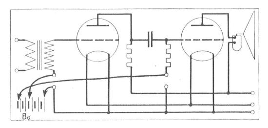
Fig. 18. Zweistufiger Verstärker.
