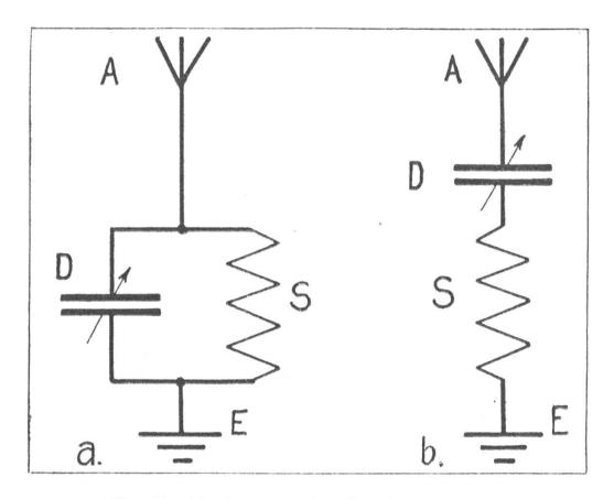
Fig. 38. Abstimmung der Empfangsantenne.
