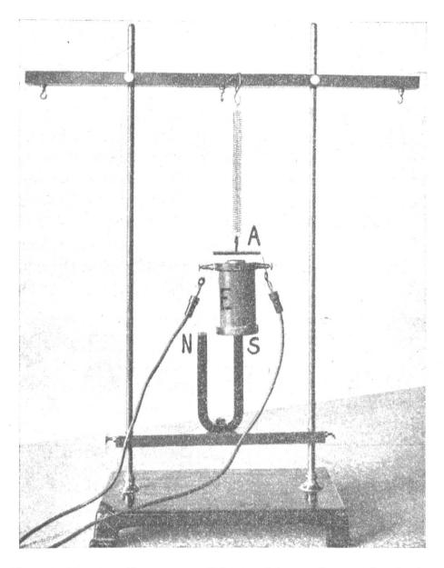
Fig. 2. Umwandlung von Wechselstrom in mechanische Schwingungen.
