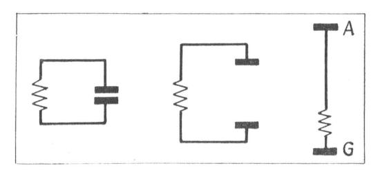
Fig. 34. Vom geschlossenen Schwingungskreis zum offenen Schwingungskreis.
