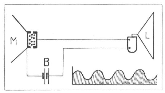
Fig. 4. Modulation des Trägerstromes durch Schallwellen.
