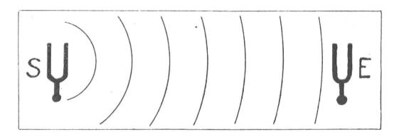
Fig. 28. Uebertragung von Schallschwingungen. 2 Stimmgabeln in Resonanz. S Sender. E Empfänger.
