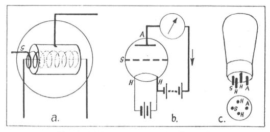
Fig. 8. Elektronenröhre mit Gitter G.
