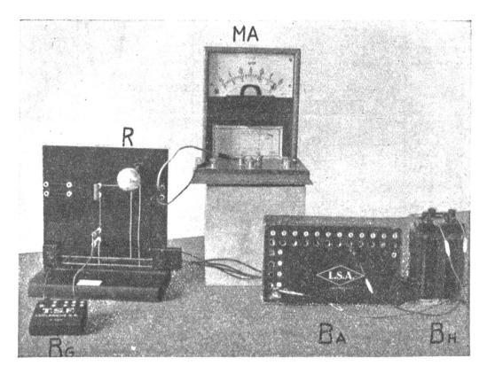
Fig. 10 Meßanordnung. R Radioröhre. MA Milliampèremeter. B<sub>G</sub> Gitterbatterie. B<sub>A</sub> Anodenbatterie. B<sub>H</sub> Heizbatterie.
