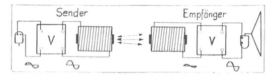
Fig. 23. Induktive Uebertragung eines Grammostromes.
