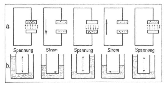
Fig. 33. Strom und Spannung.
