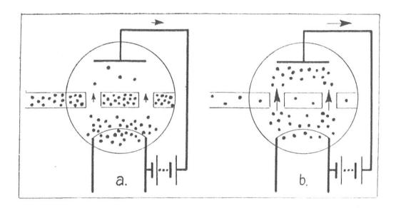
Fig. 9. Steuerung des Anodenstromes.
