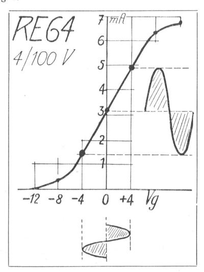
Fig. 11. Charakteristik der Röhre RE 064. Vg. Gittervorspannung in Volt. mA Anodenstrom in Milliampère.
