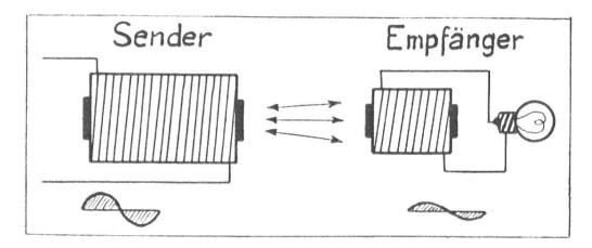
Fig. 21. Induktive Energieübertragung. Primärspule angeschlossen an 110 — 220 Volt Wechselstrom. Sekundärspule mit 4-Volt-Glühlämpchen.
