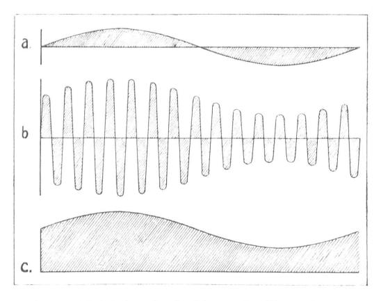
Fig. 41. Modulation des hochfrequenten Trägerstromes.
