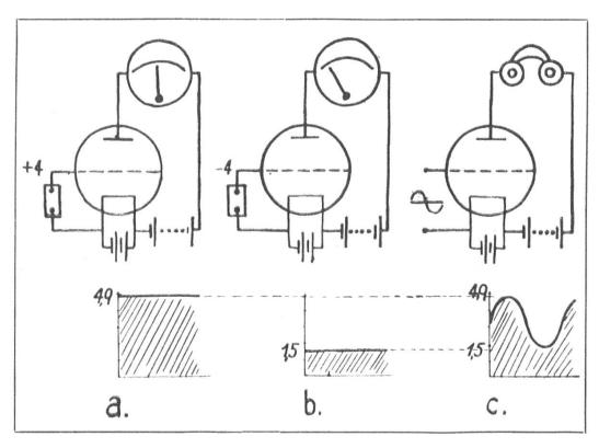
Fig. 12. Aufnahme einer Charakteristik.
