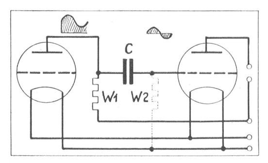
Fig. 16. Widerstandskopplung.
