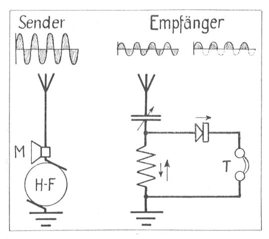
Fig. 40. Radiotelephonie (Trägerstrom unmoduliert).
