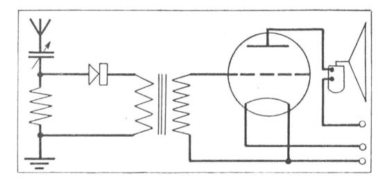
Fig. 43. Kristallempfänger mit einstufiger Niederfrequenzverstärkung, Schaltung "kurz".
