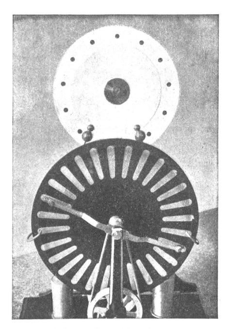
Fig. 24. Dauer eines elektrischen Funkens. Kreisscheibe auf Schwungmaschine. Influenzmaschine zur Erzeugung der Funken.
