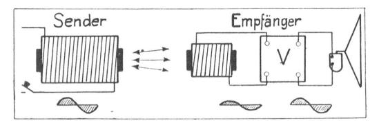
Fig. 22. Induktive Energieübertragung. V Verstärker.
