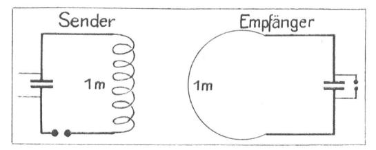
Fig. 29. Selbstinduktion. Sender und Empfänger verstimmt.
