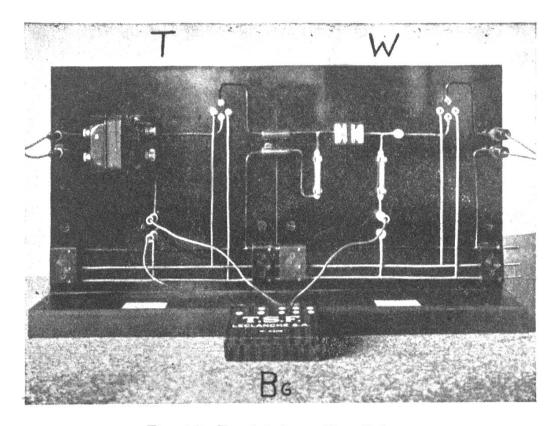
Fig. 19. Zweistufiger Verstärker.
