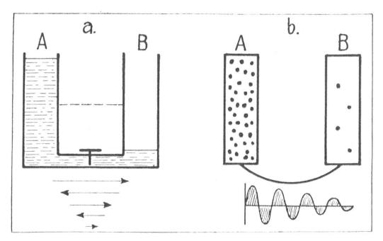
Fig. 25. Gedämpfte Schwingung.
