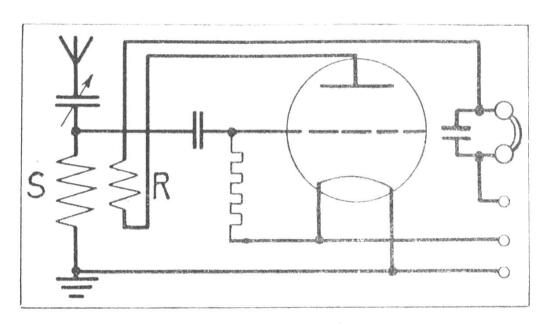
Fig. 46. Rückkopplungsaudion, Schaltung "kurz".
