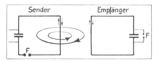
Fig. 27. Uebertragung des hochfrequenten Wechselstroms.
