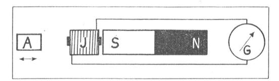
Fig. 1. Umwandlung von mechanischen Schwingungen in Wechselstrom.
