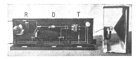
Fig. 44. Kristallempfänger mit einstufiger Niederfrequenzverstärkung, Schaltung "lang".
