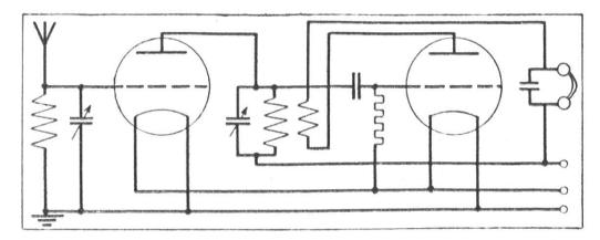
Fig. 48. Rückkopplungsaudion mit Hochfrequenzverstärkung.
