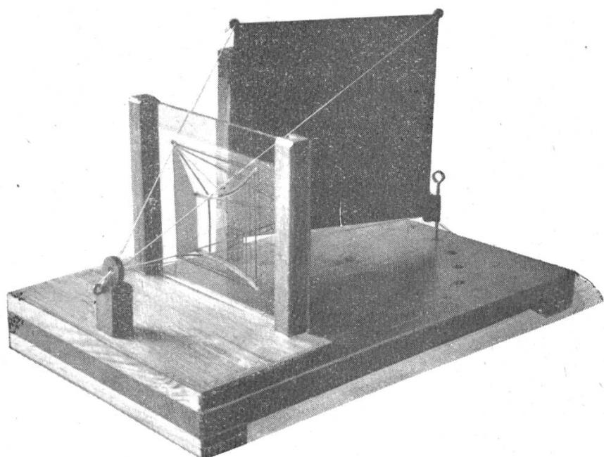
Bohrungen und Schlitze sind das einzige, was man bei Verwendung von Glas nicht selbst machen kann. Da dieser Teil des Apparates zudem ziemlich teuer ist, so nehme man dafür eventuell eine durchsichtige Zelloidplatte. Für meine Schulverhältnisse genügen folgende Masse: Objectplatte  $20 \times 20$  cm; Abstände von der Glasscheibe beiderseits 10 cm, damit die Schlitze nicht zu flach werden und möglichst zusammenlaufen. Das feste Auge stehe so, dass die zwei Schlitze nicht symmetrisch werden.
