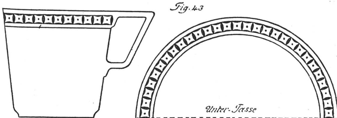
7. *Verzieren von gebrannten Tassen, Tellern und Töpfen mit Porzellanfarbe* (siehe Fig. 43). Die Gefäße werden mit Terpentinöl sauber gereinigt und die mit demselben Terpentinöl verdünnte Farbe vermittelst eines feinen Marderpinsels aufgetragen. Zu den einfachen Motiven genügen wenige Farben (La croix dorée, Blau-Violett, auch Braun). Fertige Arbeiten sorgfältig brennen.
