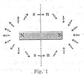
gehängten magnetischen Nähnadel nachweisen. (Eine Nähnadel wird magnetisiert und
