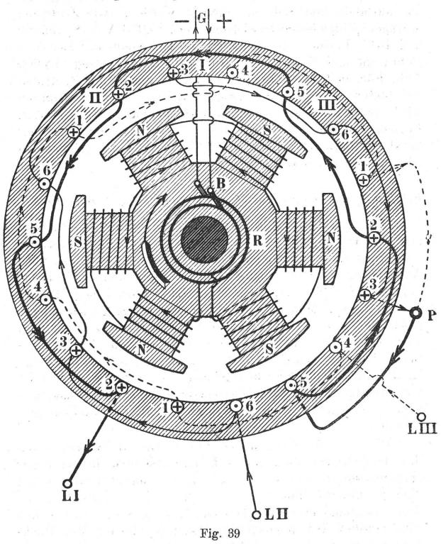
den Wicklungen, denen sich die Elektromagnete nähern, im Abnehmen in den Wicklungen, von denen sie sich entfernen.
