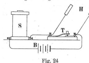
und ein Taster T eingeschaltet. An die beiden Klemmen des Tasters sind die Handhaben H geschlossen. Solange kein Eisenkern in der Spule ist, sind die Empfindungen beim Öffnen des Stromes nur schwach; sie werden unangenehm, wenn
