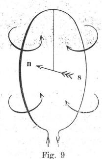
Die Vereinigung vieler Schleifen ergibt eine Spule (ein Solenoid). Die Kraftfelder der einzelnen Schleifen setzen sich
