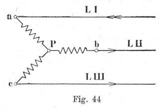
einigt (P in Fig. 39 und 44). In jedem Augenblick fließt von diesem Punkt gerade soviel Strom ab, als zufließt. Für die Fernleitung des Dreiphasenwechselstromes sind daher nur drei Drähte notwendig (sie werden an die Klemmen LI, LII, LIII, Fig. 39, angeschlossen). Auch in den Dreiphasenwechselstromtransformatoren werden die Enden der Niederspannungswicklung sowie die Enden der Hochspannungswicklung je miteinander verkettet.
