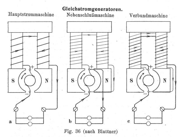
Benutzt man aber nur einen Teil des Ankerstromes zur Erregung der Elektromagnete, indem man den Strom nach Verlassen der positiven Bürste in zwei Teile spaltet, von denen der schwächere als Erregerstrom durch die aus dünnem Draht bestehende Magnetwicklung, der stärkere als Nutzstrom in das Netz geschickt wird, so nennt man die Maschine eine Nebenschlußmaschine (Fig. 36b).
