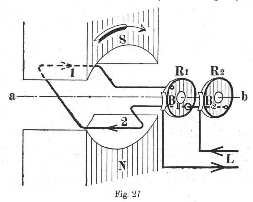
Enden des Drahtes werden zu isoliert auf der Achse befestigten Schleifringen  $R_1$  und  $R_2$  geführt. Bürsten  $B_1$  und  $B_2$  entnehmen von diesen den Strom und führen ihn der Leitung zu, in die ein Vertikalgalvanoskop geschaltet ist. Da dieses keine Wechselströme rascher Folge anzeigen kann, muß bei der Drehung immer angehalten werden, wenn das Rechteck senkrecht zu den Kraftlinien steht. Die Nadel des Vertikalgalvanoskops schlägt im Takte unserer Drehung nach links und rechts aus.
