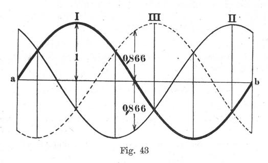
Höchstwert erreicht wird, die andern beiden Ströme je nur halb so stark sind und in der dem ersten entgegengesetzten Richtung fließen. Auch außer diesen Momenten sind die Ströme von zwei Stromkreisen zusammen immer so stark wie der im dritten Stromkreis und diesem entgegengesetzt. Oder: In jedem Augenblick ist die algebraische Summe der Ströme in den drei Phasen gleich Null.
