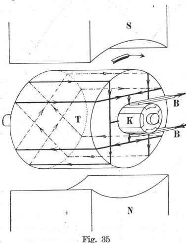
Kollektorlamelle in die Leiter auf der Seite der untern Trommel. Nach einer Drehung von haben die Leiter ihren Platz vertauscht. Die jetzt auf der Vorderseite der Trommel senkrecht verlaufenden Leiter liegen dann wagrecht und der Strom fließt. durch die jetzt stromlosen Lamellen in die Leitung und zurück.
