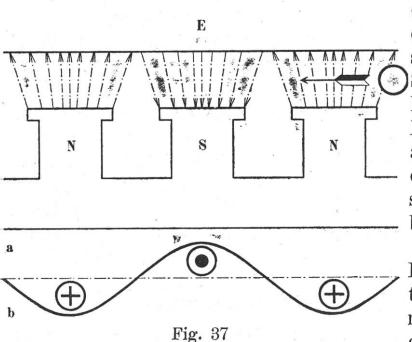
gegenüber liegenden Eisenkörper ein und aus diesem wieder in die Südpole aus. Sie liegen vor der Mitte der Pole am dichtesten: in der Mitte zwischen zwei Polen befindet sich eine Indifferenzzone. Ein gerader Leiter bewegt sich mit gleichförmiger Geschwindig-
