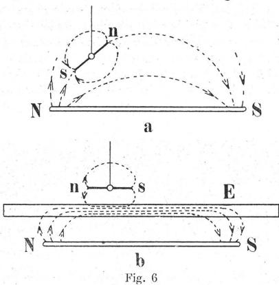
Die elektrischen Maschinen werden so gebaut. daß möglichst viele Kraftlinien durch das Eisen verlaufen, und möglichst wenig durch die Luft, daß die Streuung ein Minimum sei: darum wird auch die Entfernung der Magnetpole vom Anker auf ein Minimum reduziert.
