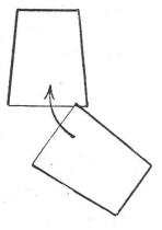
Bringe ins Gleichgewicht. Kehre das Gefäß nun um und trage Sorge, daß keiner der anhaftenden Wassertropfen neben die Wagschale fällt. (Der leichte Wasserstoff entweicht, die Wagschale mit dem Erlenmeyer sinkt.)
