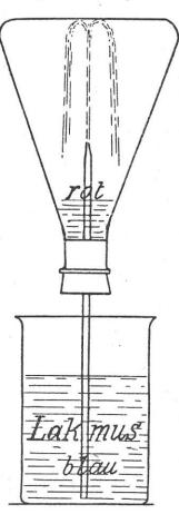
einen großen Teil des Gasvolumens absorbieren, entsteht im Erlenmeyer ein luftverdünnter Raum, der weitere Flüssigkeitsmengen nachsaugt. Im Erlenmeyer ist aus der Vereinigung von Gas und Wasser eine sehr verdünnte Salzsäure entstanden, die Lackmus rötet.)
