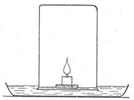
Fülle den Teller mit Wasser. Befestige ein dünnes Kerzenstümpfchen von höchstens 2 cm Länge mittelst eines Tropfens Stearin auf einer Korkscheibe oder einem kleinen Brettchen von  $4 \times 4$  cm, so daß das Ganze frei schwimmt. Entzünde und lasse eine Weile ruhig brennen. Stülpe ein Trinkglas oder Becherglas über die brennende Kerze samt Schwimmer, so daß der Innenraum des Glases vollständig abge-
