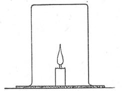
mit die innere Luft vollständig abgeschlossen ist. Beobachte. (Die Flamme wird kleiner und kleiner und erlischt dann.)
