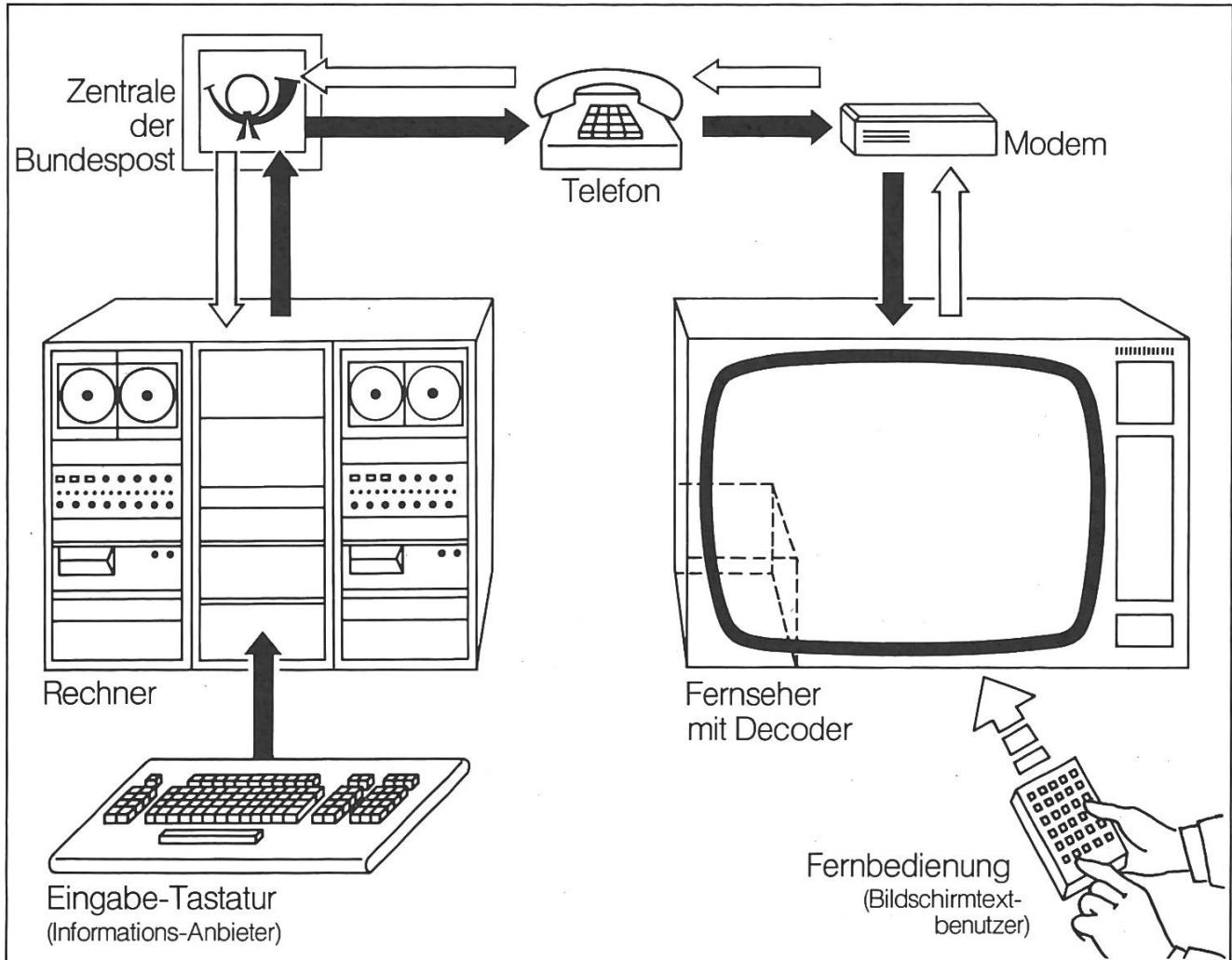
Wie funktioniert Videotex? Die wichtigsten Elemente nach einem Diagramm der deutschen Bundespost.
