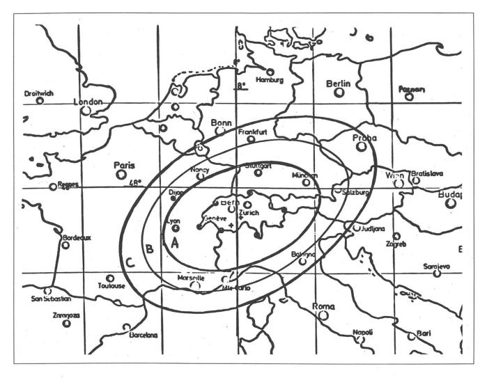
An der internationalen Wellenkonferenz in Genf erhielt die Schweiz drei Bereiche mit elliptischem Querschnitt zugesprochen. Dauernd mit einem genügenden Signal bedeckt wird vor allem die Nutzellipse A. Mit grösseren Parabolantennen von Gemeinschaftsanlagen kann der Empfang auch noch innerhalb der Ellipse C sichergestellt werden.
