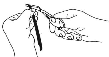
Zum Kleben der Tonbänder verwendet man am besten die Klebeschiene. Das Tonband wird mit der Schichtseite nach unten in die Schiene eingelegt und mit zwei Fingern aneinandergeschoben.
