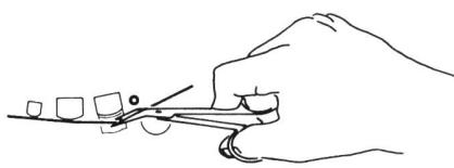
Diese Methode ist ebenfalls sehr exakt und dazu wesentlich schneller, erfordert aber etwas mehr Übung. Die beiden Bandenden, die wieder zusammengefügt werden sollen, müssen genau aufeinander passen. Dies kann durch Übereinanderlegen der Bandenden (Schnittseiten nach unten) und einen feinen Korrekturschnitt unter einem Winkel von etwa 45° erreicht werden.
