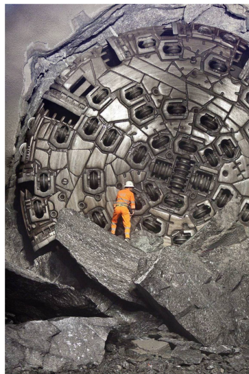
Heidi, eine der vier gigantischen Tunnelbohrmaschinen, die den Gotthard durchstossen haben.
