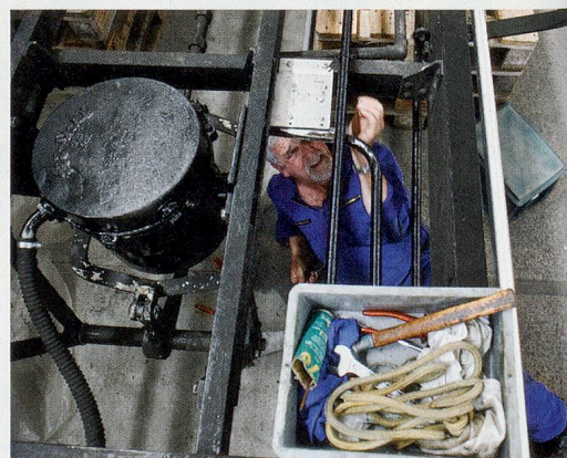
Grosses Bild: Hansueli Schneeberger (links), Fred Ming (rechts) und Walter Zimmerli (vorne) bauen den frisch revidierten Bremszylinder ein. Bild links: Ruedi Tobler bei der Arbeit an der Heizung.
