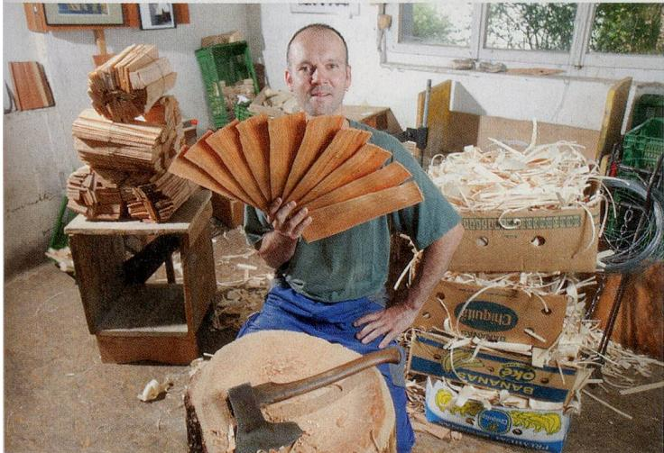
die Hälfte aller Aufträge machen solche holzverkleideten Neubauten mittlerweile aus. Pro Quadratmeter benötigt der Schindelmacher etwa hundert Schindeln und eine Arbeitsstunde: Er muss die Schindeln in der Wuchsrichtung platzieren und annageln. Bis das Dach einer Alphütte mit durchschnittlich 80 bis 100 Quadratmetern Fläche verschindelt ist, dauert es schon ein paar Tage. Dafür sollte es ein Jahrhundert lang halten.
