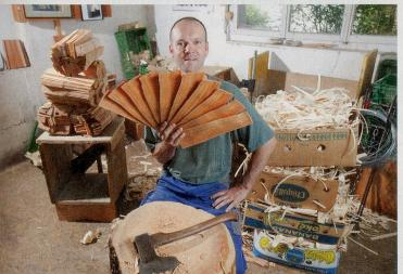
die Hälfte aller Aufträge machen solche holzverkleideten Neubauten mittlerweile aus. Pro Quadratmeter benötigt der Schindelmacher etwa hundert Schindeln und eine Arbeitsstunde: Er muss die Schindeln in der Wuchsrichtung platzieren und annageln. Bis das Dach einer Alphütte mit durchschnittlich 80 bis 100 Quadratmetern Fläche verschindelt ist, dauert es schon ein paar Tage. Dafür sollte es ein Jahrhundert lang halten. Martina Novak
