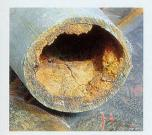
Derart verrostete Rohre sind keine Seltenheit. Die dicke Rostschicht bewirkt eine Rohrverengung und einen damit verbundenen Druckabfall sowie Rostwasser.
