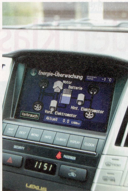
Transparente Information: Das Display zeigt an, welcher Motor gerade arbeitet.
