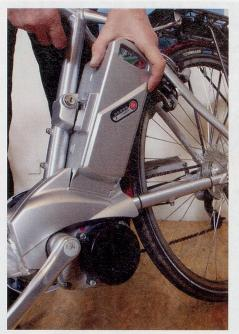
**Klein und leicht:** Die moderne Batterie lässt sich zum Laden locker entfernen.
