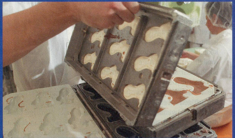
Die zweite Hälfte: In Metallrahmen werden die beiden Hasenhälften zusammengesetzt. Und ab gehts in die Schleudermaschine.
