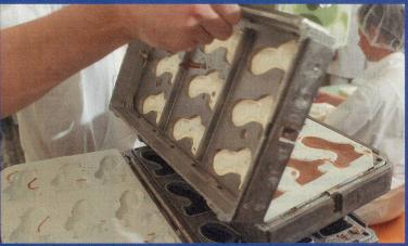
**Die zweite Hälfte:** In Metallrahmen werden die beiden Hasenhälften zusammengesetzt. Und ab gehts in die Schleudermaschine.
