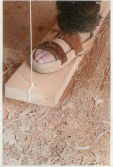
**Gaspedal aus dem Mittelalter:** Damit hält Sepp Steiner die Drechselbank in Schwung.
