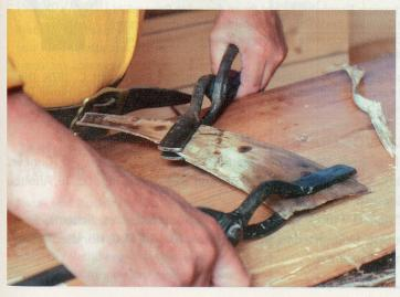
Tell stösst in sein Horn: Ein Kuhhorn wird für den Hornschichtbogen zurechtgebogen.
