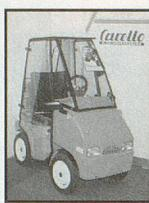
2 starke Elektro-Motoren überwinden jede Steigung bis 30%
