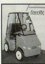
2 starke Elektro-Motoren überwinden jede Steigung bis 30%
