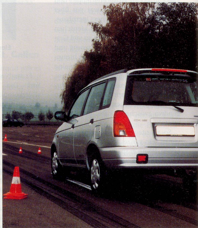
Vollbremsung mit ABS: Der Wagen geht vorn «in die Knie» ohne Rauch.
