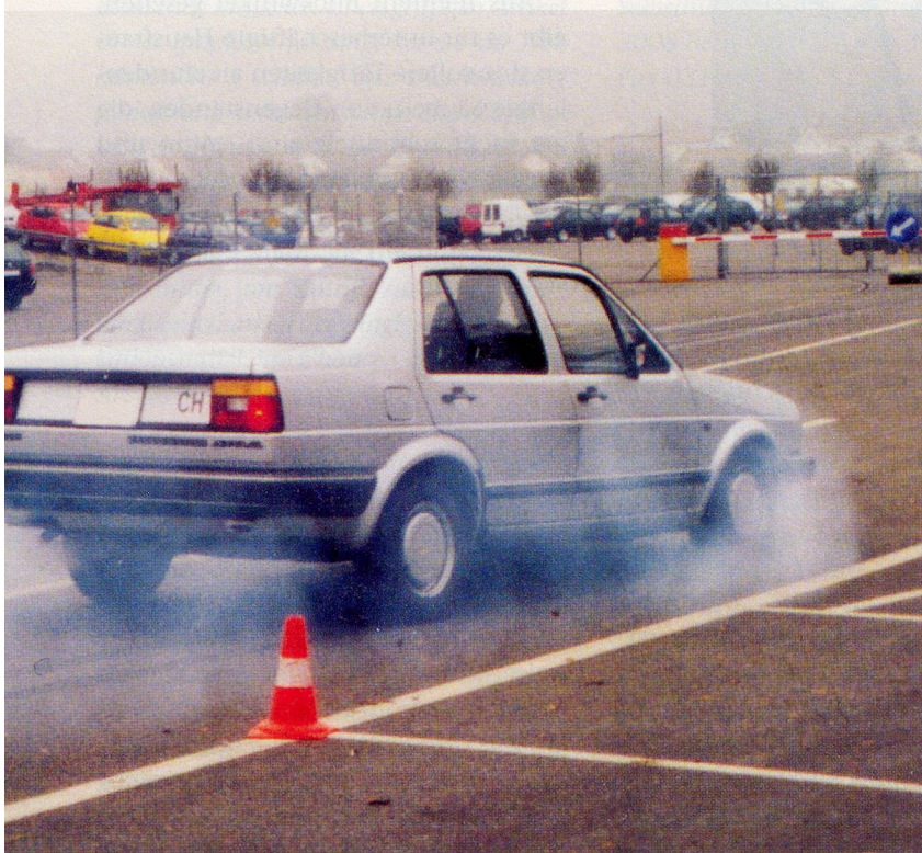
Vollbremsung ohne ABS (Antiblockiersystem) mit 80 km/h. Bremsweg 52 m. Pneubrieb 1–2 mm.
