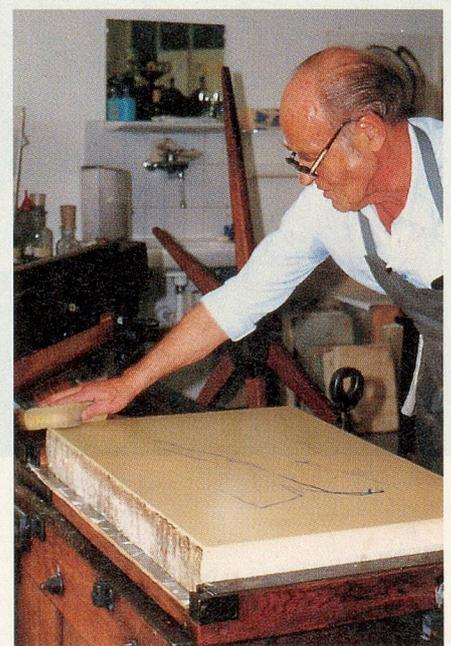
Bevor die Farbe eingewalzt werden kann, befeuchtet Willi Steinauer den Stein mit einem nassen Schwamm.
