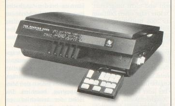
Das Vorlesegerät «Reading Edge» kommt aus dem Hause XEROX/USA. Es wurde für Menschen entwickelt, deren Sehkraft, z. B. altersbedingt, so schwach ist, dass ihnen das Lesen eines Buches fast nicht mehr möglich ist.
