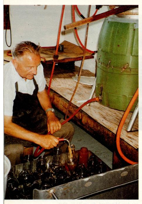
Im grünen Chromstahlbottich wird der Saft während einer halben Stunde mit Starkstromelektroden auf 70 Grad erhitzt und so pasteurisiert. Zinsstag füllt die Flaschen ab, die im Wasserbad zuvor auf 45 Grad erwärmt wurden, sonst würden sie springen.
