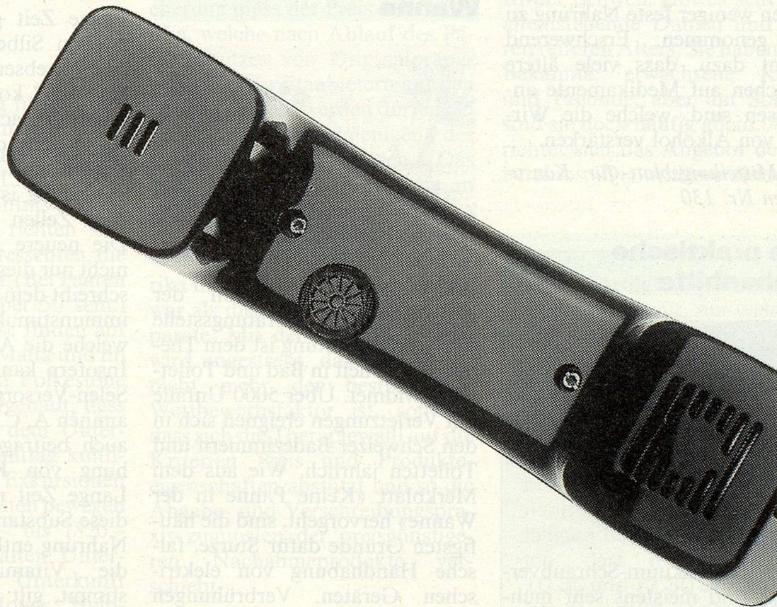
Bei lärmiger Umgebung oder bei Hörproblemen ermöglicht der Telefonhörer eine einwandfreie Verständigung. Sind Sie Hörgeräteträger, dann verstehen Sie Ihre Gesprächspartner dank der eingebauten Streufeldspule induktiv über Ihr vertrautes Hörgerät klar und deutlich. Der Installateur passt die hohen, mittleren und tiefen Frequenzgänge Ihrem Gehör an.
