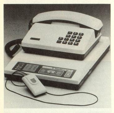
Das von der PTT angebotene Telealarm-Gerät besteht aus einem tragbaren Minisender und einem Zusatzgerät zum Telefonapparat.
