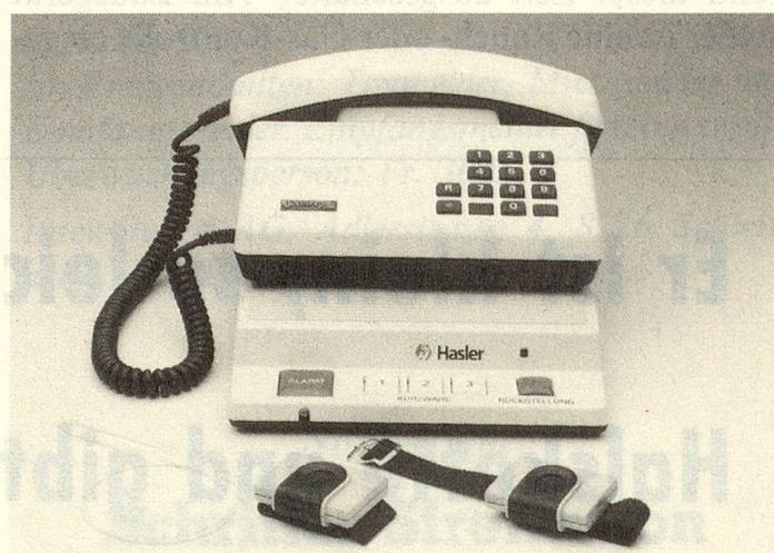
Das Ascom-Hasler-Personennotruf-System ist in drei Varianten erhältlich. Zur Grundausstattung gehört das Notrufgerät, bestehend aus dem Geborgenheitstelefon und einem Netzgerät. Eine Alarmtaste, die entweder mit einer Kordel um den Hals gehängt oder wie eine Armbanduhr am Handgelenk getragen werden kann, vervollständigt die Grundausstattung. Für grössere Wohnungen kann das Gerät durch zusätzliche Lautsprecher ausgebaut werden.
