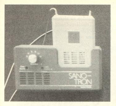
Während der Nacht steckt man das Traggerät zum Laden des Akkumulators in das Ladegerät. Dieses kann man an jede Steckdose anschliessen. Mit einem Knopf kann die gewünschte Ruhezeit eingestellt werden – der Summton bleibt während dieser Zeit ausgeschaltet. Am Ladegerät selber ist eine Rauch- oder Gas-Kontrolle eingebaut. Sie löst bei Gas- oder Brandausbruch automatisch Alarm aus.
